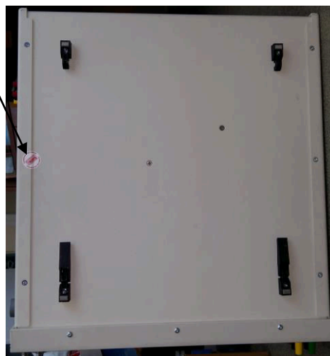
Рисунок 3 – Место пломбировки от несанкционированного доступа
