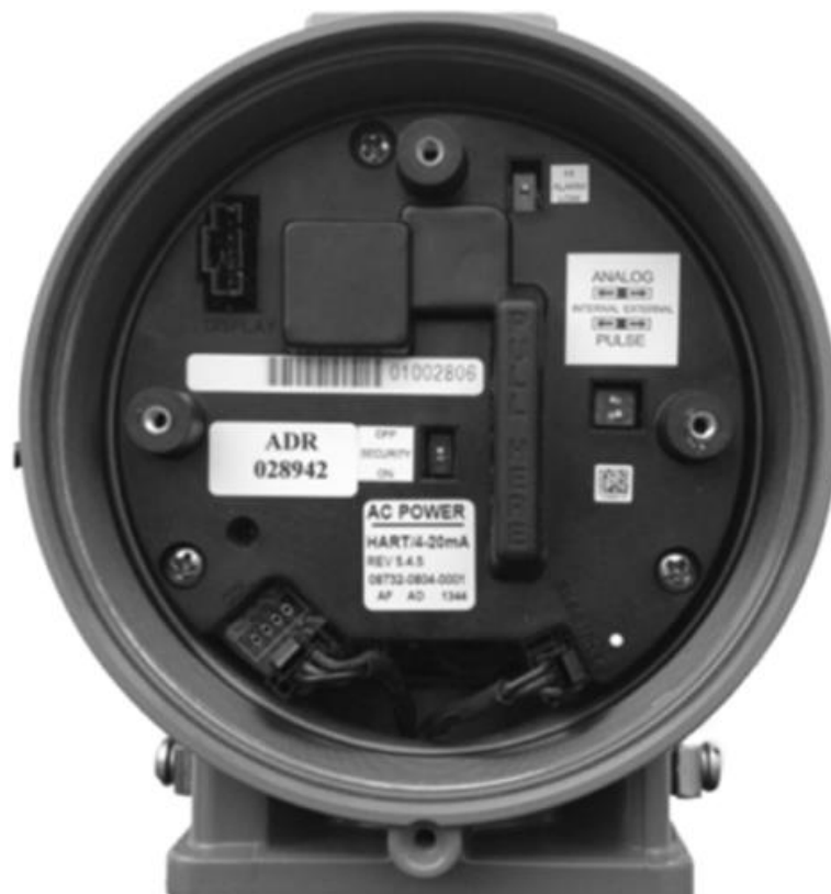
Рисунок 2.24 – Расположение переключателей на плате электроники преобразователя
