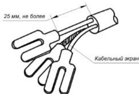
Рисунок 2.15 – Подготовка кабелей цепи электродов и катушек возбуждения
