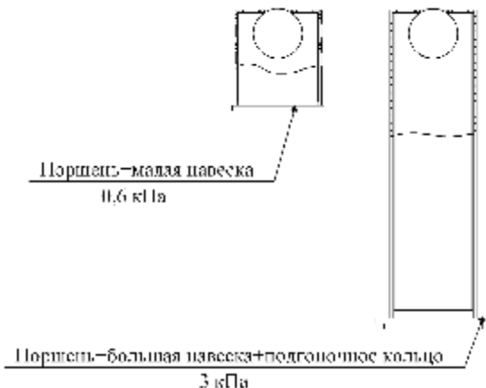
Рисунок 2 – Поршень и навески калибратора давления пневматического
