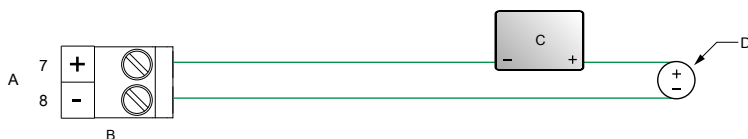
Рис. 3-24: Подключение миллиамперного входа (с внешним питанием)
