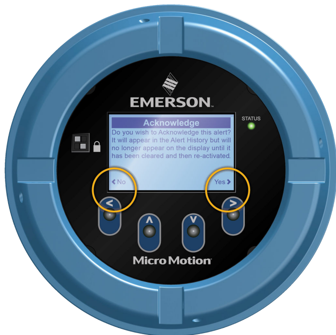
Рис. 7-3: Пример 2: Активные стрелочные индикаторы на дисплее измерительного преобразователя
