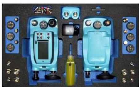
Ударопрочный влагонепроницаемый чемодан на колесах с выдвижной ручкой. Рассчитан для укладки двух станций задания давления PV 62xG, калибратора DPI 620 Genii, адаптера модулей давления MC 620G, модулей давления PM 620 и других принадлежностей.
