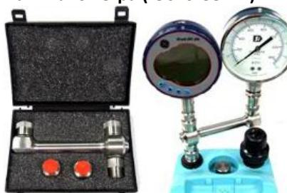
Устанавливается на станцию задания давления, благодаря чему станция PV 62xG преобразуется в помпу для сравнительной калибровки манометров.
