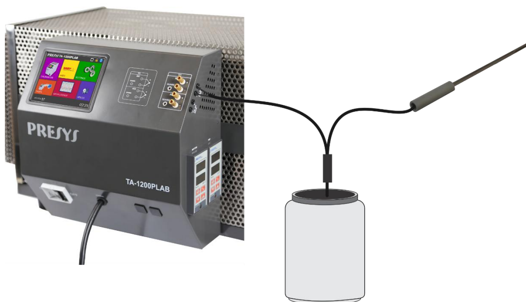
Рис. 12 - Подключение эталонного датчика в качестве внешнего эталона
