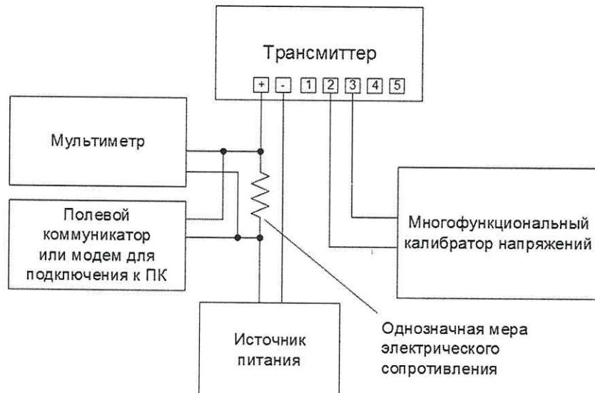
а) для преобразователей с цифровым выходным сигналом на базе протокола HART
