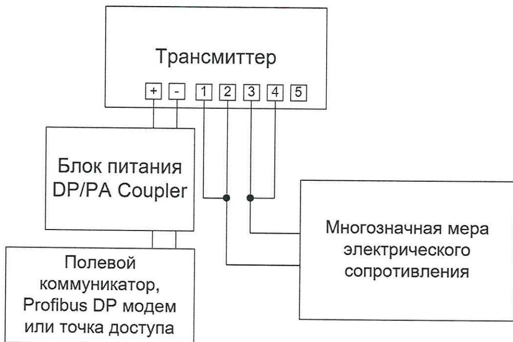
в) для преобразователей с цифровым выходным сигналом Profibus PA
