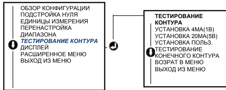
Рис. 2-17. Выполнение тестирования аналогового контура с помощью локального интерфейса оператора
