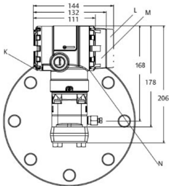
**Рис. 10. Преобразователь давления 2051L для измерения уровня.**
