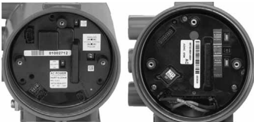
Рисунок 8-4. Измерительный преобразователь полевого монтажа — Идентификация платы электроники
