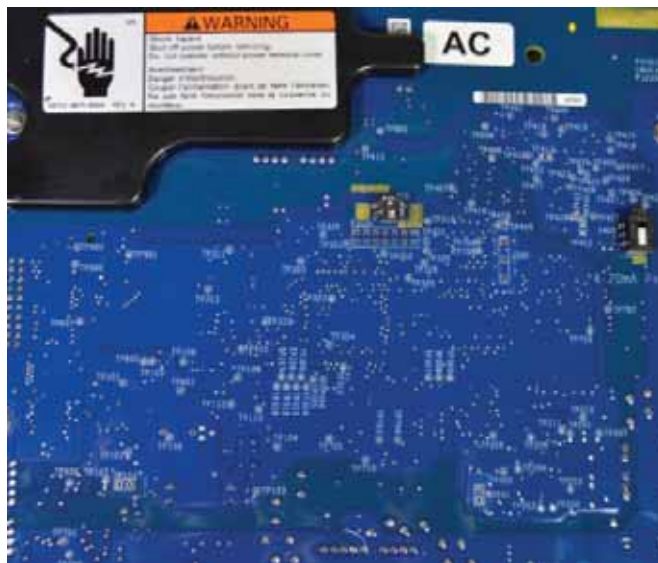
Рисунок 3-2. Электронная плата измерительного преобразователя настенного монтажа и аппаратные переключатели
