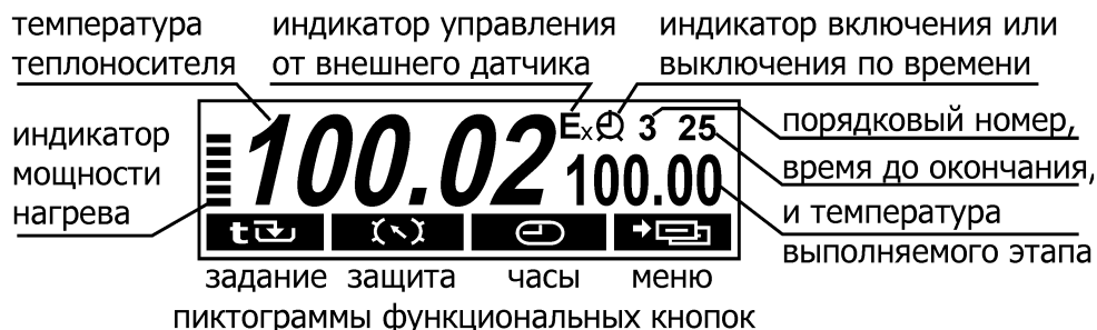
Рисунок 5 — Дисплей в режиме регулирования по программе
